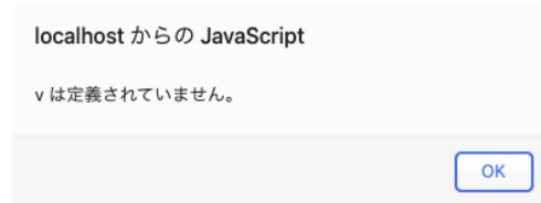
図 3 未定義変数を検知した際のアラート
